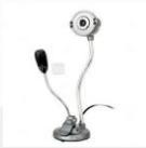
Se utilizan los dispositivos conectados a la computadora como micrófonos y webcams, ya sea conectados por USB o incluidos en computadoras portátiles para tomar la señal de audio y video .
